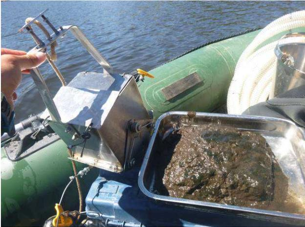
Benne Eckman et prélèvement de sédiment
