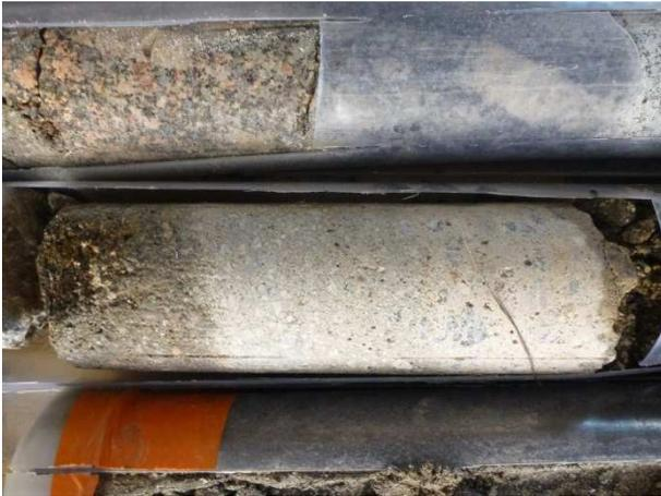
Figure 13-9 : Lit de béton à l'interface (SC2)
