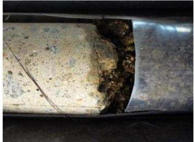
Figure 13-10 : Lit de béton non collé à la fondation (SC2)
