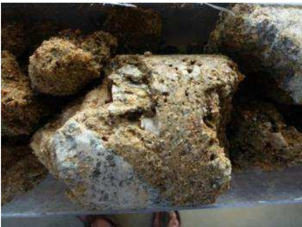
Figure 13-3 : Mortier altéré, poreux et friable (SC3)
