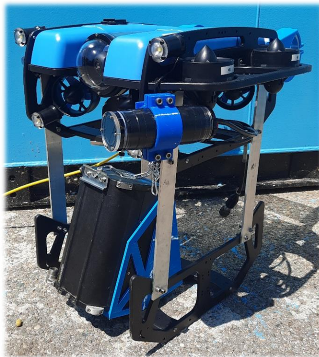
ROV JIFMAR BlueROV2 avec sa caméra acoustique
