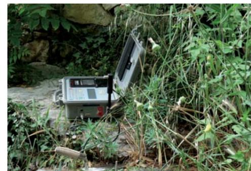
Capteur permettant de détecter les vibrations en cours de scellement et valise d'enregistrement des tirs de mine au hameau de Peyremale.
