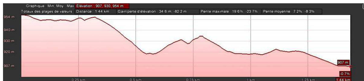
Profil en long de l'interconnexion
