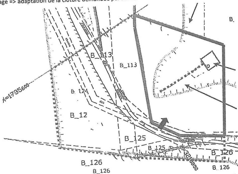
Pour le captage des Monts, l'hydrogéologue agréé impose, en lieu et place d'une clôture de fils barbelés, la mise en place d'une clôture grillagée infranchissable par l'homme et les animaux, de hauteur 2 m et d'un portail d'accès maintenu fermé à clé. Nous retenons une clôture de type simple torsion (maille de 50 mm et fil de ø3,1 mm) sur piquet en fer de ø40mm.
