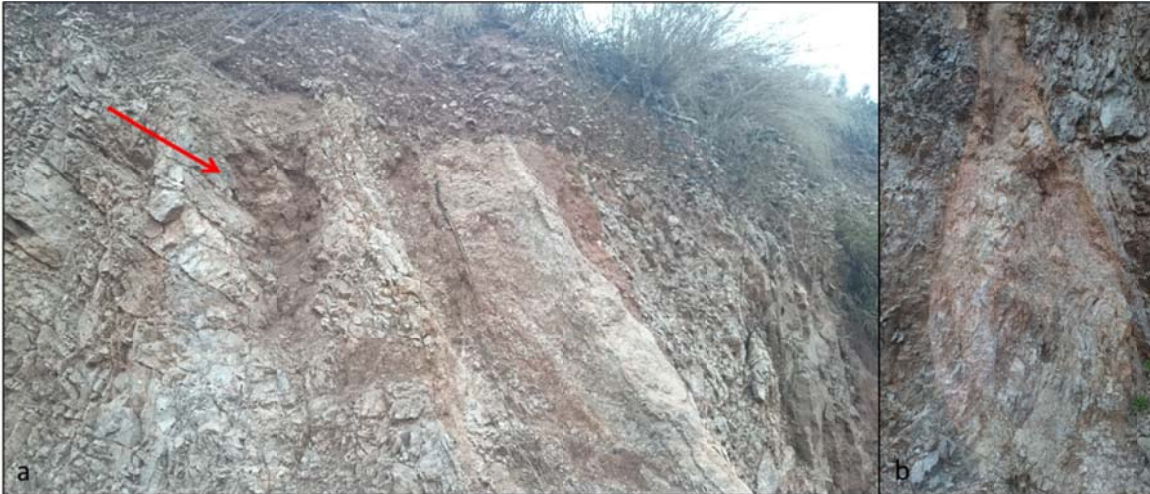
Illustration 8 : Dans la partie ouest de la carrière, les failles se matérialisent par des zones fortement altérées
