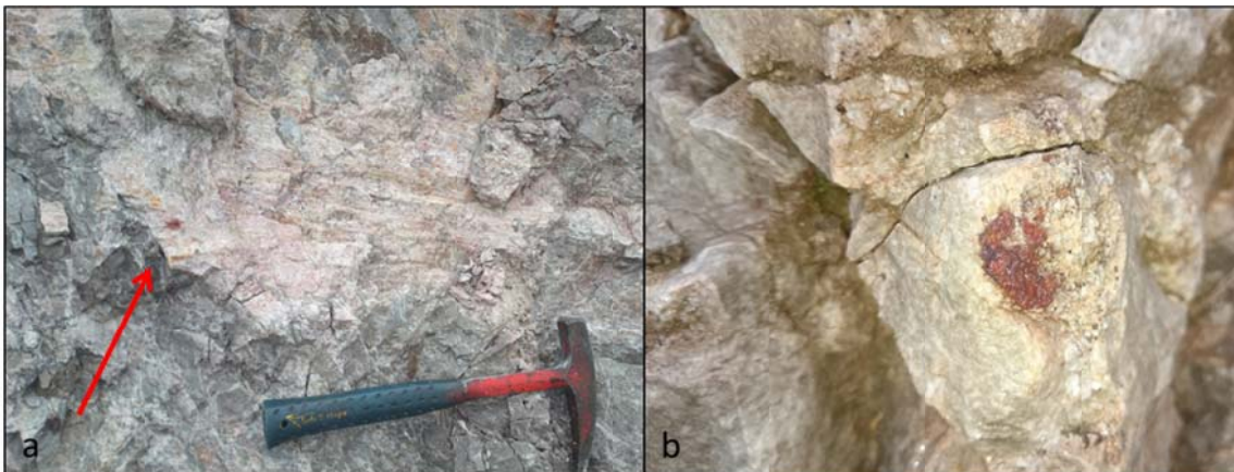
Illustration 9 : Plan de faille (a) avec placage infra-millimétrique (b) d'hydroxyde de fer.
