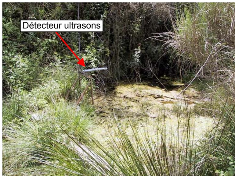
Fig. 6 - Mesure du débit de drainage de la digue (seuil jaugeur et détecteur ultrasons).
