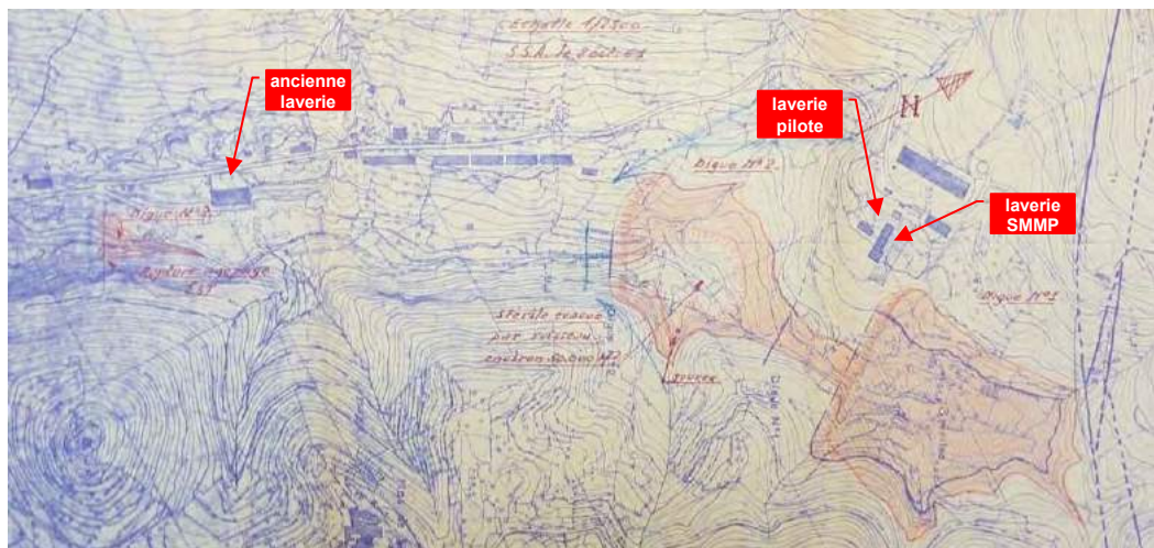
SMMP, plan des 3 bassins de décantation après la rupture de 1961 (arch. DREAL 5.4.10, SSA-044)
