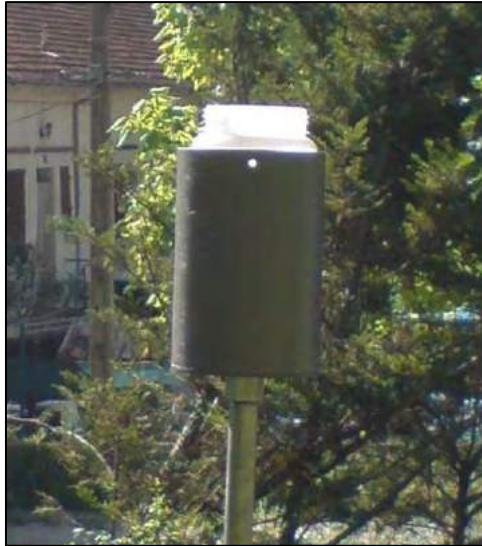
Photographie 9 : Collecteur en PEHD 21 pour les métaux (source : rapport INERIS DRC-18-162397-00395A)
