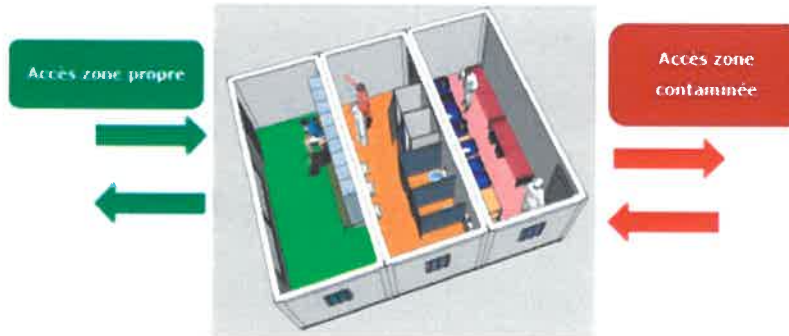
Figure 2 : Exemple d'un SAS de décontamination
