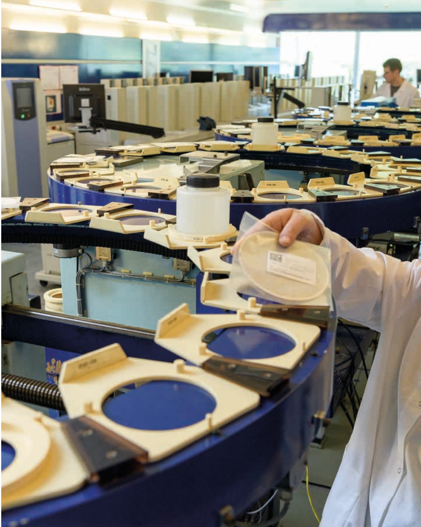
Chaîne de spectrométrie gamma pour la mesure des filtres d'aérosols atmosphériques
