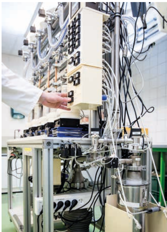
Banc de dégazage de l'hélium-3 pour la mesure du tritium marin
