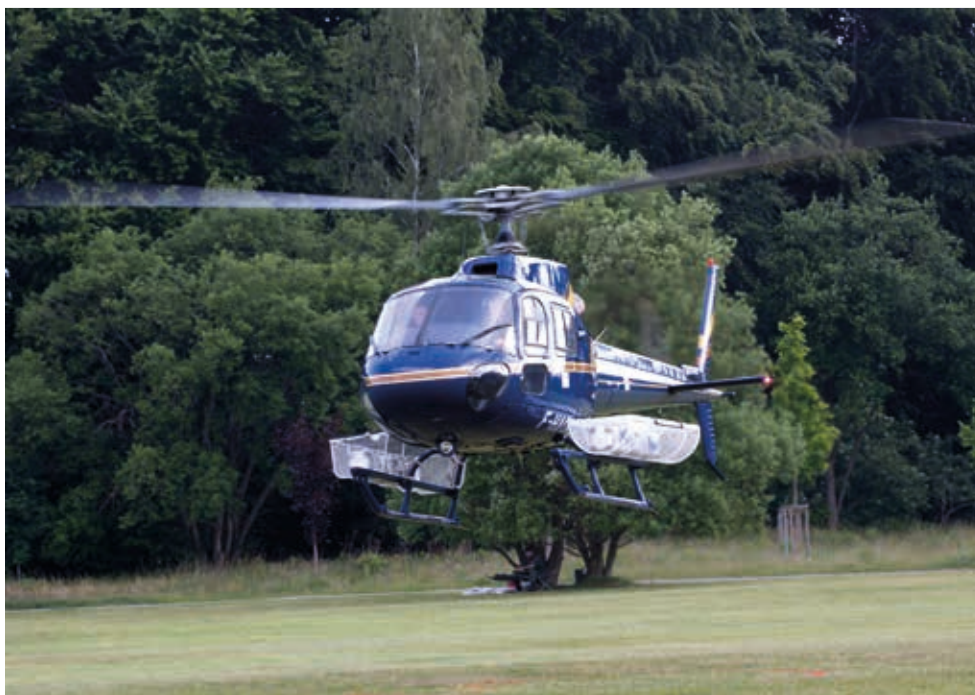
Dispositif de spectrométrie gamma embarqué Ulysse de l'IRSN; les détecteurs sont dans les nacelles de chaque côté de l'hélicoptère. C'est ce dispositif, mais embarqué dans un avion, qui a permis l'obtention de la carte de la figure 5A.
