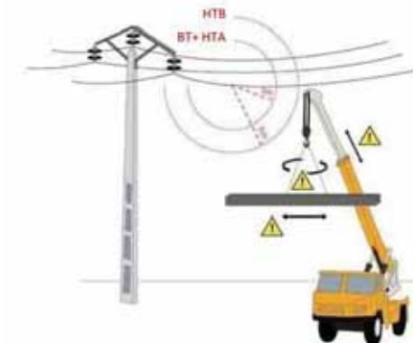
Figure 130 : Illustration du calcul des distances à l'ouvrage électrique aérien (Source : INERIS)
