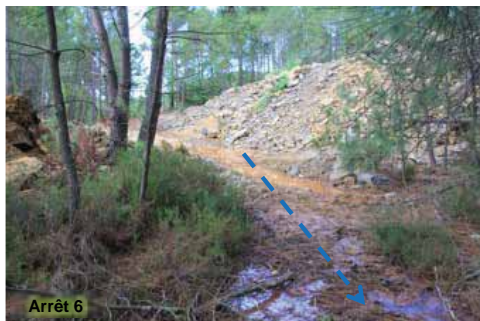
Photo 41 – Ecoulement le long des pistes sur le 1 er carreau d'exploitation
