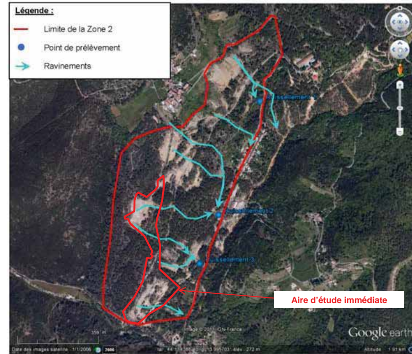
Figure 147 – Représentation cartographique des principaux ravineaux observés sur la zone 2 (anciennes exploitations à ciel ouvert) et localisation des points de prélèvements (Source : ICF-Environnement / ADEME)
