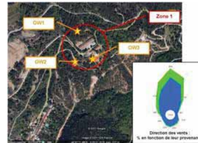
Figure 135 : Localisation des points de prélèvements pour l'envol de poussières (Source : ICF-Environnement)
