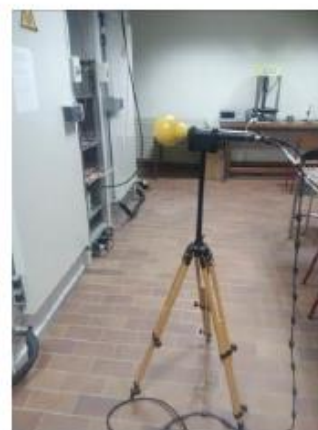
Figure 5-2: niveau de champ magnétique dans la bande de fréquences utilisée pour le CPL Linky Mesure dans un laboratoire éclairé par des tubes fluorescents à ballast électronique
