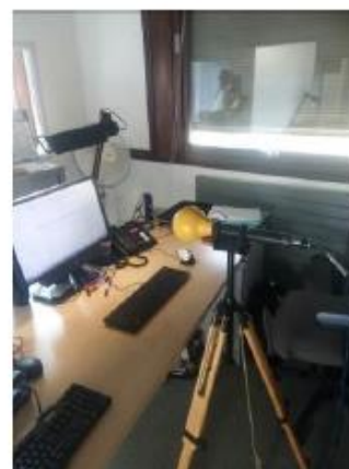
Figure 5-1: niveau de champ magnétique dans la bande de fréquences utilisée pour le CPL Linky Mesure sur un poste de travail, devant un écran plat d'ordinateur
