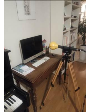
Figure 5-5: niveau de champ magnétique dans la bande de fréquences utilisée pour le CPL Linky Mesuré dans un logement, devant un écran plat d'ordinateur
