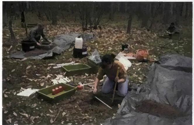
Prélèvements d'échantillons de sols sur la profondeur 0 - 10 cm. E. Ulrich / ONF
