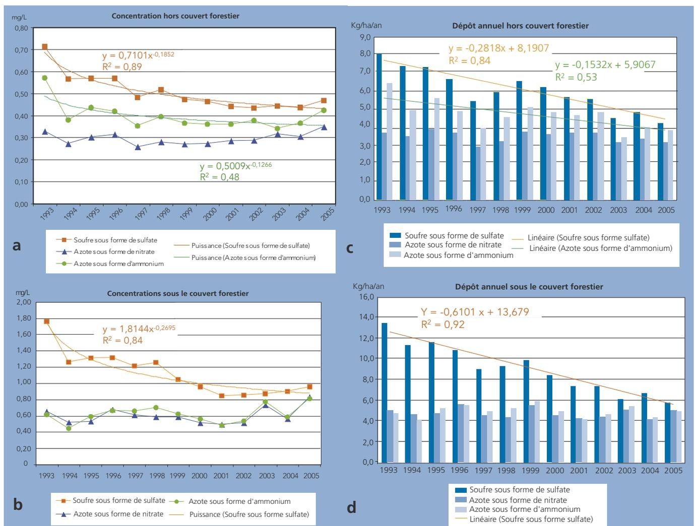
Fig. 4 : évolution de 1993 à 2005 des concentrations moyennes nationales (pondérées par la pluviométrie) (a et b) et des dépôts annuels moyens (c et d) des 27 sites hors et sous couvert forestier pour le soufre (sous forme de sulfate S-SO<sub>4</sub>), l'azote sous forme de nitrate (N-NO<sub>3</sub>) et l'azote sous forme d'ammonium (N-NH<sub>4</sub>)
