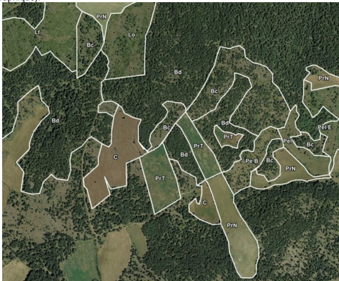
Fig 1: Exemple de photo-interprétation grâce aux nuances de structure. Bd – Bois dense ; Bc – Bois clair ; Lf – Lande fermée ; Lo – Lande ouverte ; Pel – Pelouse ; PelE – Pelouse embroussaillée ; PelB – Pelouse boisée ; PrN – Prairie naturelle ; PrT – Prairie temporaire ; C – Culture
